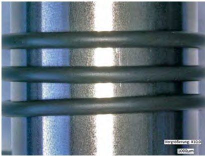
Bild 3: Auch nach künstlicher Alterung bei 150 °C in Luft und anschließendem Aufdehnen um 50% nimmt der neue PFAS-freie Gleitlack keinen Schaden (Bild: O-Ring Prüflabor Richter GmbH)
