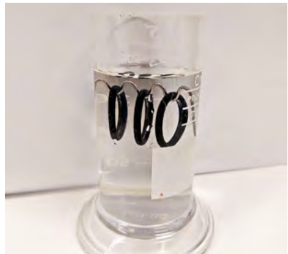
Bild 2: Bei Einlagerungstests in Referenzölen, Kraftstoffen und destilliertem Wasser stellt die neue Beschichtung ihre chemische Beständigkeit unter Beweis
