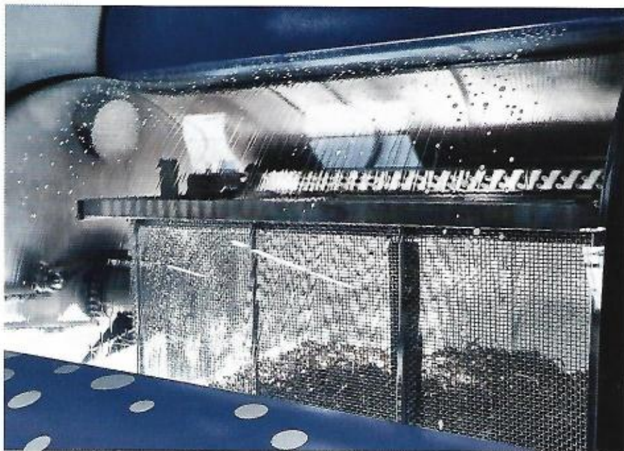
O-Ringe durchlaufen im ersten Schritt des optimierten Vorbehandlungsprozesses eine Nassreinigung mit Temperaturkontrolle und speziellen Reinigern.
