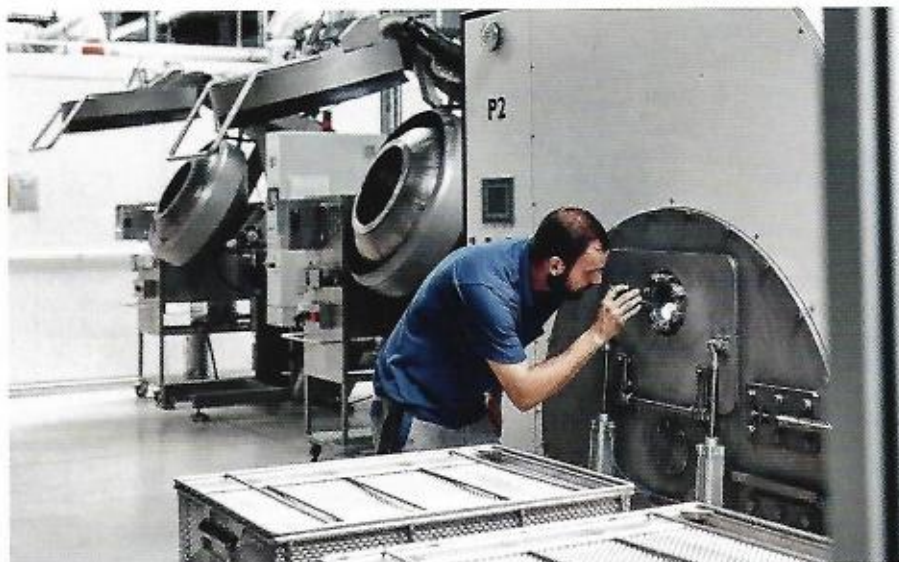
Im zweiten Schritt des optimierten Vorbehandlungsprozesses für Silikone werden die O-Ringe im Hochfrequenz-Niederdruckplasma aktiviert, hier prüft ein Mitarbeiter visuell den Prozess.
