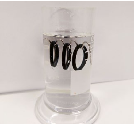
Bild 1: Einlagerungstests in Referenzzölen, Kraftstoffen oder destilliertem Wasser zeigen die chemische Beständigkeit der neuen Beschichtung
