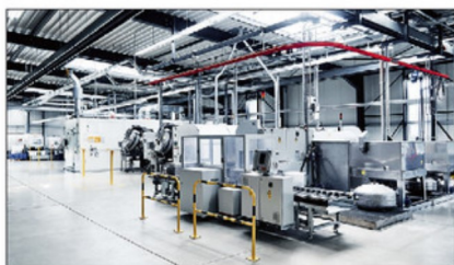
Diese Anlage erlaubt den wirtschaftlichen Einsatz des Hochfrequenz-Plasmas (Bild: APO GmbH)
