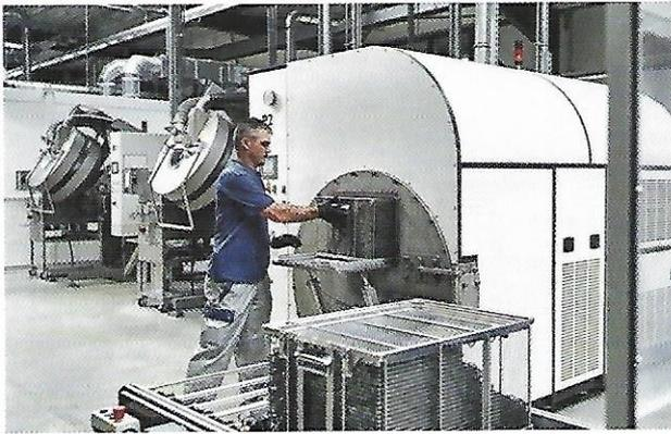
Bild 1: Niederdruckplasmaanlage für die LAB Reinigung und Beschichtungsvorbehandlung in der APO GmbH
