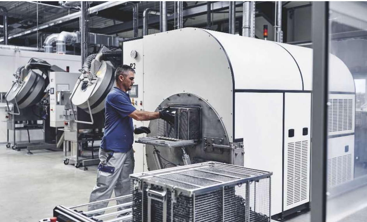
Reinigungsdienstleister Apo hat eine Niederdruckplasmaanlage für die Labs-Reinigung von C-Teilen aus Elastomeren und anderen Kunststoffen entwickelt. Bilder: Apo
